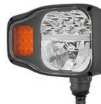
ECOWEGV1.54070 FANALE ANTERIORE EGV1 LED DX CONNETTORE DT04- 6P FISSAGGIO INFERIORE
