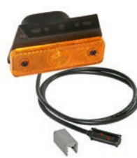
31-2814-024 SIDEPOINT LAMPADINA 24V CAVO 1,5M P&R CON STAFFA E PROTEZIONE
