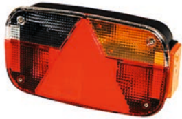
24-8271-007 MULTIPOINT 3 DESTRO 12V CON LUCE LATERALE - CONNETTORE
